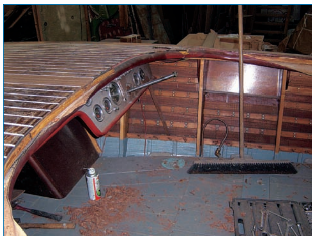
La restauration du bateau a nécessité 300 heures de travail et 28 couches de vernis.
