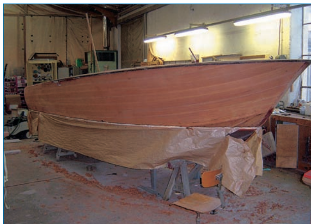
A la fin de l'été dernier, le bateau rentre en chantier, à cause d'une voie d'eau sous la pièce d'étrave.
